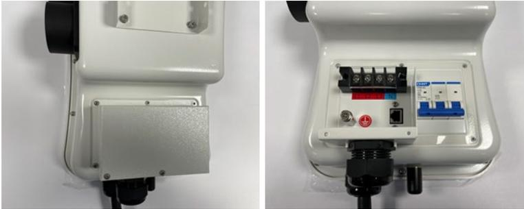
**Abb. 5-4 Öffnen der Abdeckung des Anschlusskastens**
