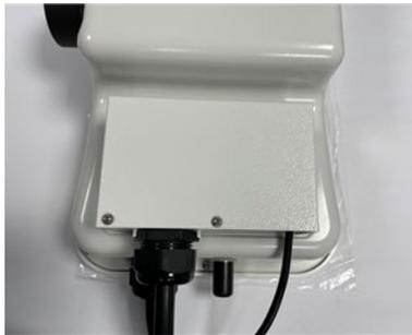
**Abb. 5-7 Schließen der Abdeckung des Verkabelungsbereiches**
