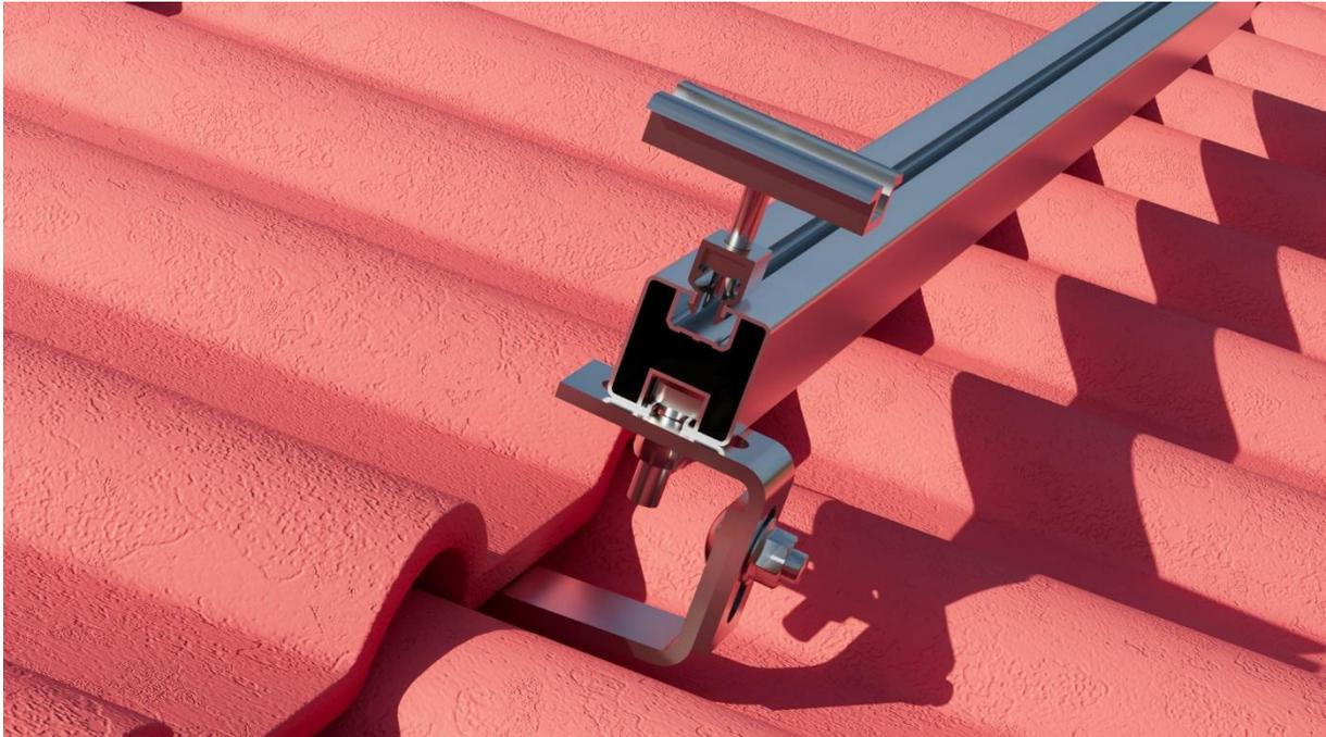
Für einen Höhenausgleich bei geschweißten Dachhaken können u.a. Unterlegscheiben zwischen Dachhaken und Montageschiene verwendet werden.
