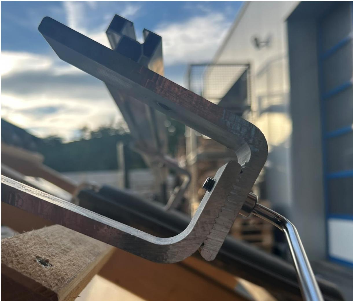
Anschließend kann der gelöste Bügel auf die gewünschte höhe verschoben werden. Um das genau einstellen zu vereinfachen haben der Bügel und der Mittelteil vorgegeben Nuten.
