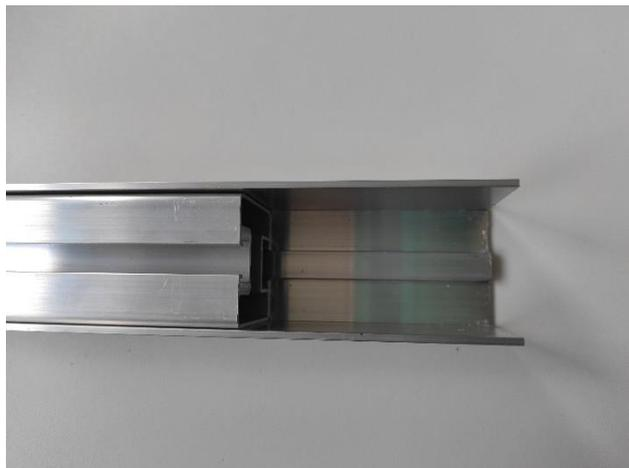
Die Schienenverbinder Typ 3 ist ein Verbindungselement, das verwendet wird, um zwei Montageschiene miteinander zu verbinden. Um die Montageschiene zu verbinden werden an Schienenende mit den Schienenverbinder durch Bohrschrauben miteinander verschraubt. An der Seite von der Montageschiene werden je 2 Bohrschrauben eingeschraubt, so dass jede Montageschiene mit 4 Bohrschrauben verbunden ist.
