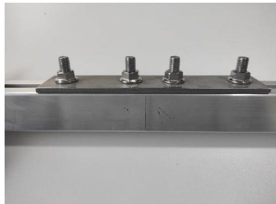
Die Schienenverbinder Typ 2 ist ein Verbindungselement, das verwendet wird, um zwei Montageschiene miteinander zu verschrauben. Um die Montageschiene zu verbinden werden an Schienenende die Sechskantschraube M10x30mm in die Führung eingeschoben, danach werden die Schrauben in die Löcher der Schienenverbinder gesteckt. Zum Schluss wird mit Sperrzahnmutter M10 auf die Gewinde geschraubt. Dies wird mit einer Ratsche von 37 Nm angezogen.
